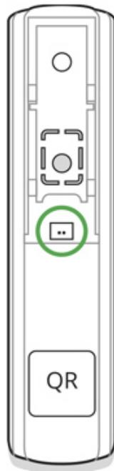
Si raccomanda di installare il rilevatore cablato a una distanza non superiore a 1 metro. Aumentando la lunghezza del cavo, aumenta anche il rischio di danneggiarlo e si riduce la qualità della comunicazione tra i rilevatori.
