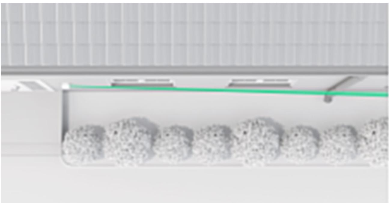
Se opportuno, attivare il **rilevamento dell'area vicina** (barra di scorrimento del **Near area detection**) per il lato desiderato. Questa modalità permette ai sensori del rilevatore di rilevare il movimento quando si tenta di rompere il corpo stesso del dispositivo, riducendo l'angolo cieco.
