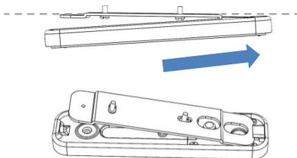
3. Una volta inserito e posizionato in modo saldo, riportate la base del sensore in posizione orizzontale facendola combaciare alla piastra di fissaggio.
