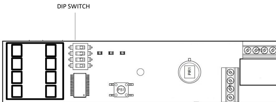
1. Selezionare DIP 1-2 propriamente a seconda dell'altezza di installazione
