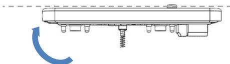
4. A montaggio corretto dovrete vedere la base del sensore posizionata orizzontalmente come da figura. Assicuratevi che sia ben salda, posizionate il coperchio applicandolo con una leggera pressione verso l'alto. Fermate il coperchio con le viti.
