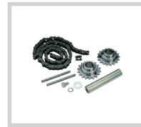
VN.RM Set rinvio moto 1:1 per albero 1" (25,4 mm) composto da due ingranaggi con diametro esterno 78 mm e catena L= 1 m.
