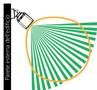
Copertura a tenda usando la maschera fissa e la staffa XD-WALLBRACKET con XD45D-ADAPTER
